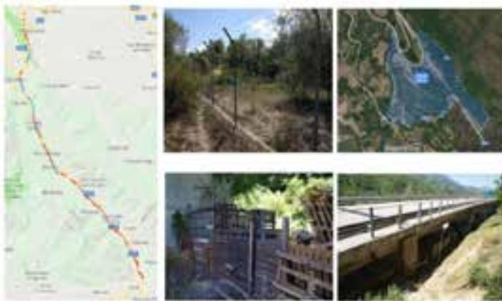
Figura 5. Lato sinistro: localizzazioni di ponti (in rosso) e di gallerie (in blu) lungo la Strada Statale 690. Lato destro: tipi diversi di infrastrutture che impediscono la percorribilità di sottopassi e sovrappassi.
